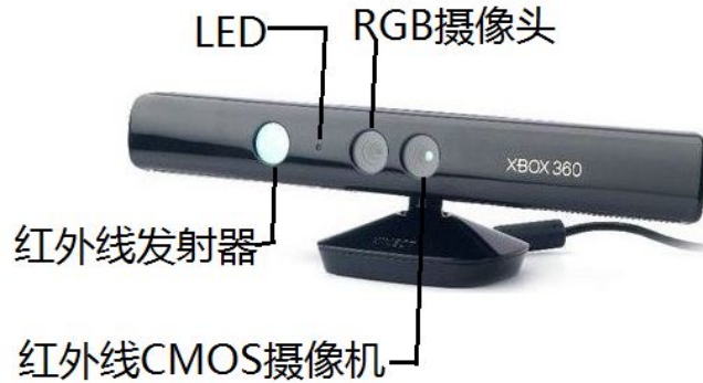
图 1.1 Kinect 结构简图
